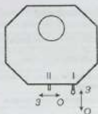
Рис. 3. Схема управления подачей воздуха для печей-каминов типа «Рейн».
